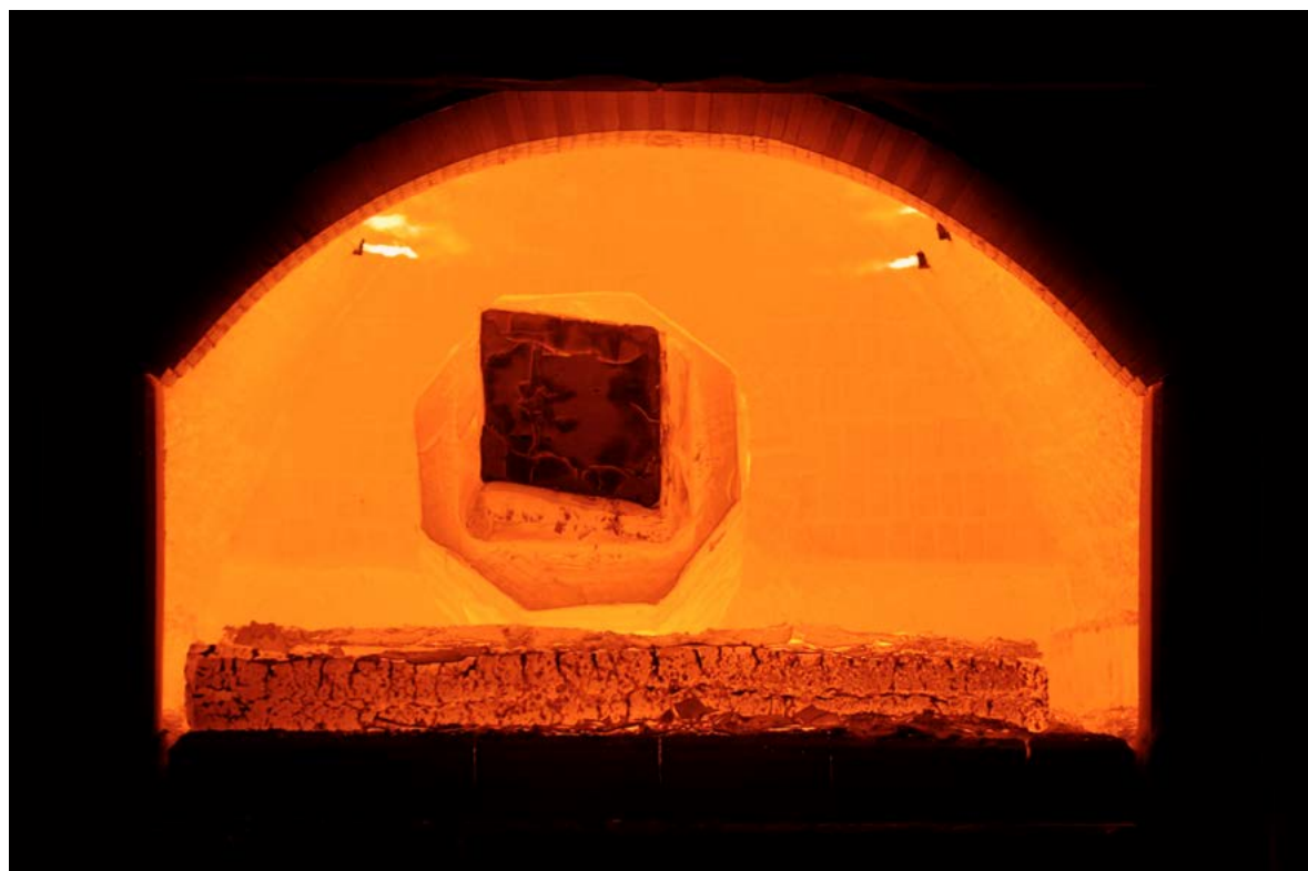
Användningen av biogas ersätter naturgas i Björneborg Steel, som här i en värmningsugn.
