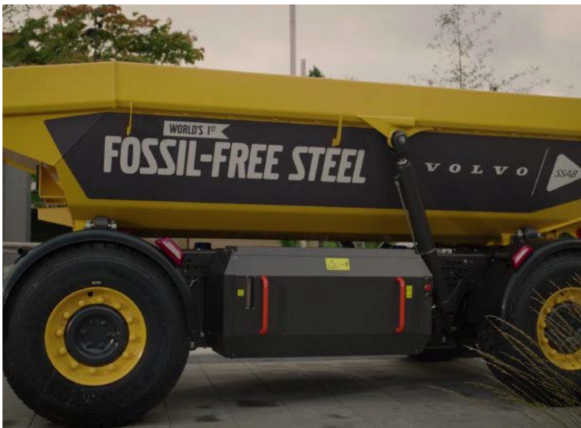
Världens första fordon i fossilfritt stål. Volvo CE:s TA 15 är en autonom och elektrisk lastbärare tillverkad i fossilfritt stål från SSAB
