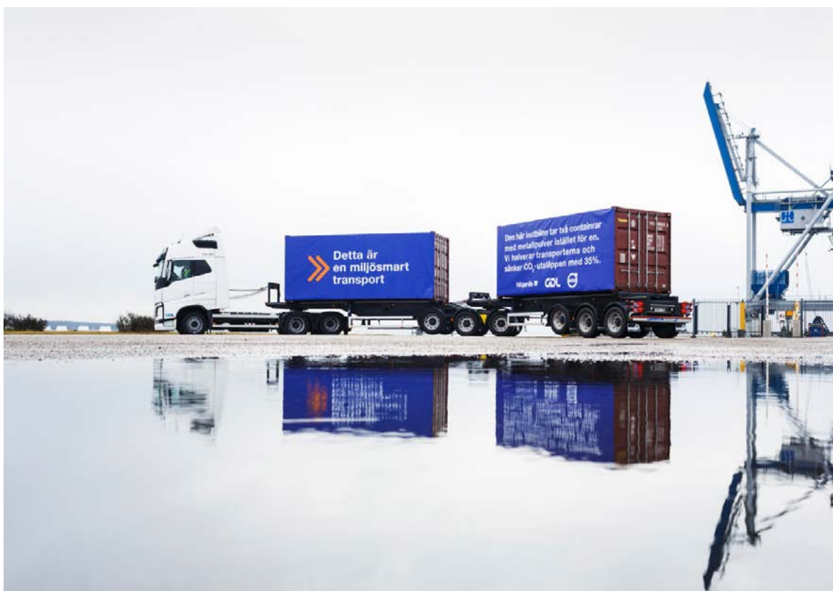
En 74-tons lastbil som tar två containrar i stället för en och därmed sänker CO2-utsläppen med 35%.
