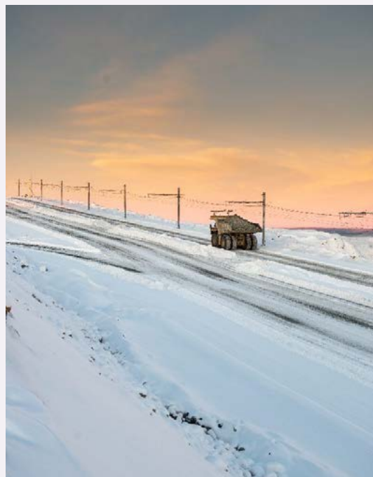
El-Trolley i Aitik. Källa: Boliden
